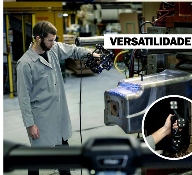
O MetraSCAN 3D conta com 15 lasers cruzados e uma alta taxa de medição para fornecer tempos acelerados de digitalização. Com uma configuração rápida, verificações em tempo real e os arquivos prontos para usar, a sequência de trabalho de medição nunca foi tão rápida. A economia de tempo na medição, aquisição e análise de dados é simplesmente impressionante!
